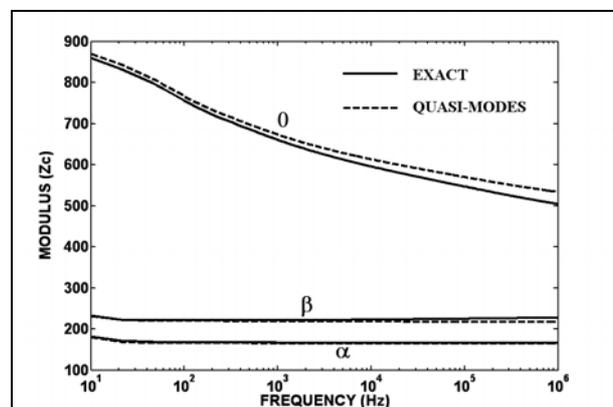
Fig. 10. The  $Z_C$  modulus – design II.
