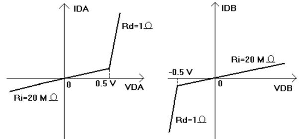
Fig. 7 Diode models
