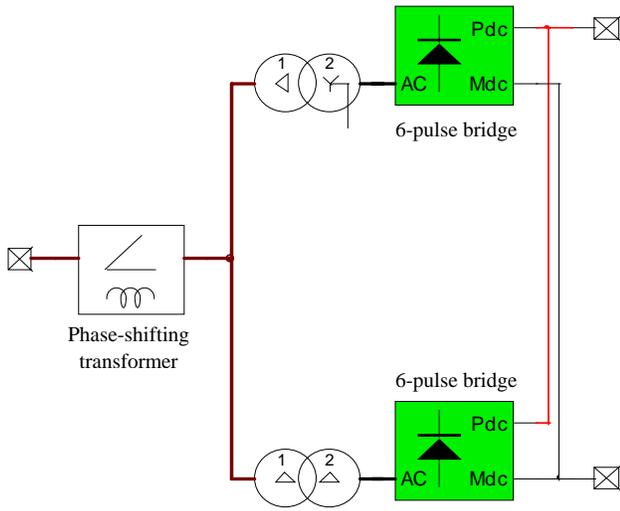
Fig. 4b. 12-pulse diode rectifier modeling (EMTP-RV)
