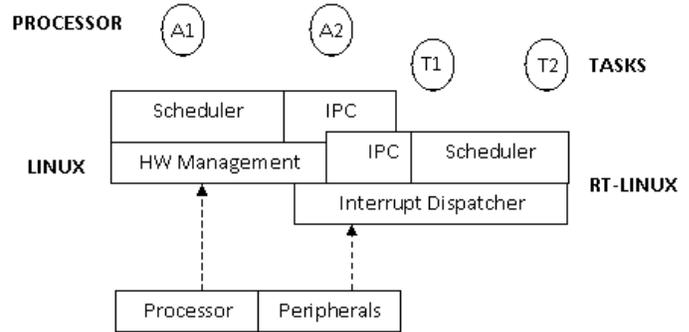
Fig. 4. Architecture of RTLinux.
