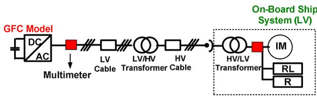
Fig. 12. Steady State System
